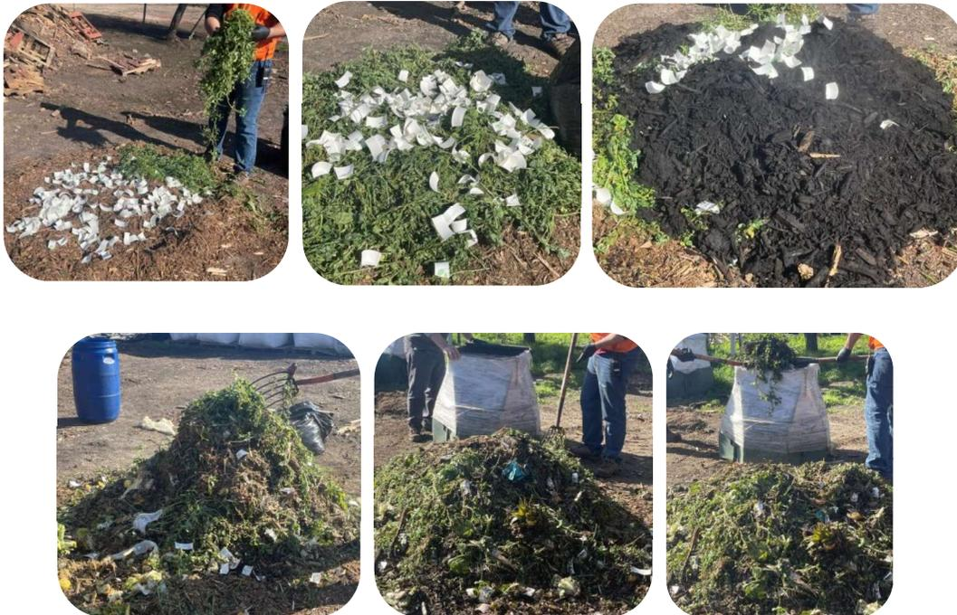
**Figura 3.** Imágenes de la incorporación de residuos orgánicos y mezcla con las muestras de Vasos de 6,5 Onzas Latam BIO 2023 en la compostera 1.
