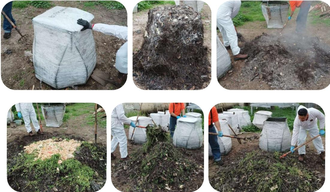
**Figura 4.** Imágenes del primer volteo del compost con muestras de Vasos de 6,5 Onzas Latam BIO 2023.
