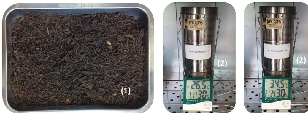
**Figura 7.** Muestra del compost obtenido (1) y determinación de Nivel de Madurez mediante el test de Autocalentamiento (2).
